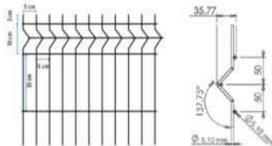
De acordo com o projeto padrão fornecido pelo FNDE (para terreno de 45 x 35 m), haverá fechamento com gradil de 1,58m de altura, com pilares metálicos e tela de aço galvanizado de tamanho fixo, instalado na parte frontal do lote, acima de mureta de alvenaria de 0,62m de altura. Caso o terreno disponível seja maior, o ente requerente poderá utilizar-se do padrão de fechamento aqui descrito para a instalação em todo o seu terreno, ficando o custeio do excedente a cargo do requerente.
